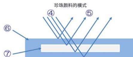
④ 入射光 ⑤ 反射光 ⑥ 金属氧化物（氧化钛和氧化铁等） ⑦ 云母・ $\text{SiO}_2$ ・ $\text{Al}_2\text{O}_3$ 等
